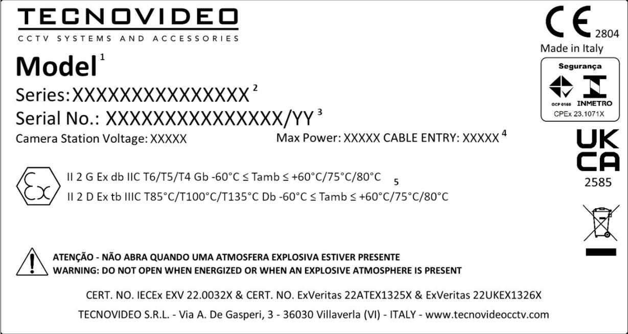
Jedes Gerät muss mit einem Kennzeichnungsschild wie das oben abgebildete ausgestattet sein. Für die nordamerikanische Produktversion siehe Kapitel 9.1 Produkt-Kennzeichnungsschild (nordamerikanische Version)
