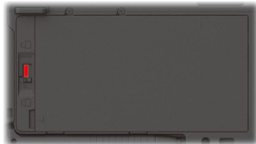
Mauvaise position (partie rouge est visible)
