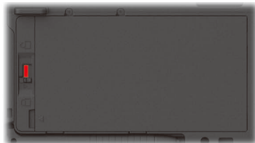
Mauvaise position (partie rouge est visible)
