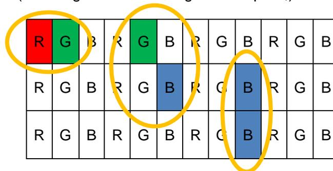
**Abstand zwischen Dots** Definition des Abstandes zwischen zwei defekten Dots, waagrecht, senkrecht oder diagonal, hell oder dunkel (z. B. folgende Anordnung und Subpixel,)
