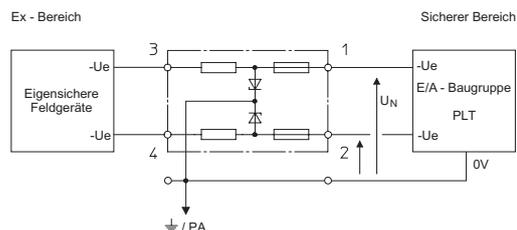
Zwei-Kanal-Sicherheitsbarrieren Potential: - / -
