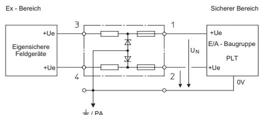
Zwei-Kanal-Sicherheitsbarrieren Potential: + / +
