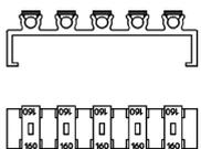
Sicherungshalter wird an der Seite einer Sicherheitsbarriere aufgeklipst und kann mit bis zu 5 Vorsicherungen (Ersatz) bestückt werden.
