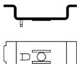
Der Adapter erlaubt die Montage einer Sicherheitsbarriere auf dem Klemmfuß (Art. Nr. 165283) oder einer Montageplatte einer Vorgängerbaureihe.
