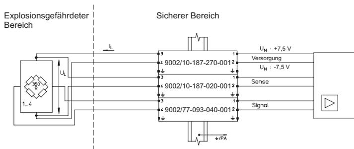
Anwendungsfall: Wägezelle (DMS) 350  $\Omega$  oder 700  $\Omega$
