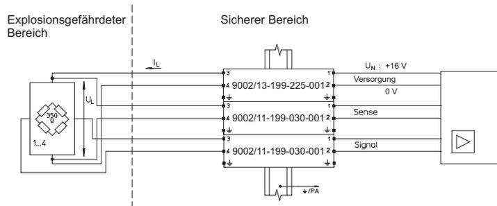
Anwendungsfall: Wägezelle (DMS) 350 Ω oder 700 Ω
