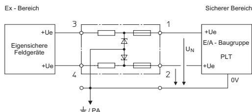
Zwei-Kanal-Sicherheitsbarrieren Potential: + / +
