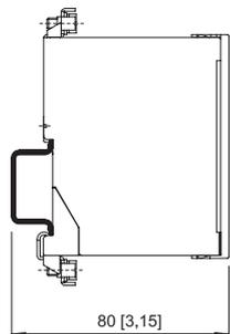
montiert auf Tragschiene NS 35/15
