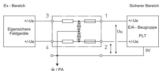
Zwei-Kanal-Sicherheitsbarrieren Potential: ~ / ~
