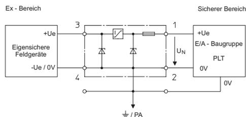
Ein-Kanal-Sicherheitsbarrieren mit elektronischer Strombegrenzung für positives Potential mit Spannungsbegrenzung
