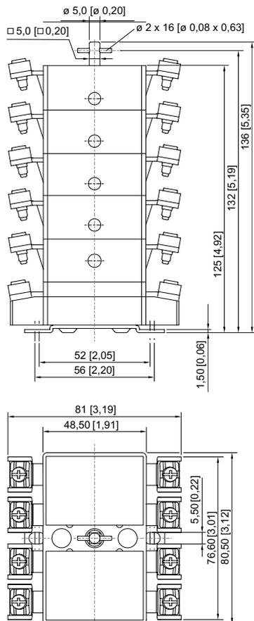
Last- und Motorschalter Reihe 8006/4, 9-polig und 10-polig
