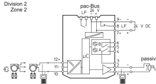
Feldgerät                      ISpac Trennstufe                      SPS / PLS
