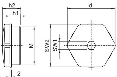
M = Taille de filetage    d = Cote d'angle
