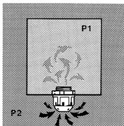
Les différences de pression résultant de la différence de température entre l'intérieur du boîtier (P1) et l'atmosphère ambiante (P2) sont compensées de manière sûre via le bouchon respirateur. La formation de condensation à l'intérieur du boîtier est ainsi réduite à un minimum.
