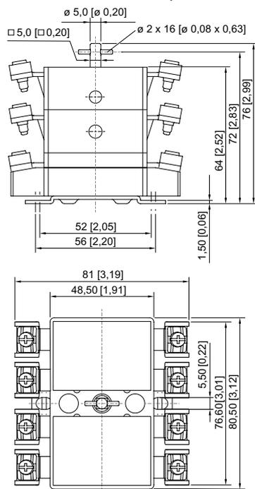
Interrupteur de puissance/moteur série 8006/4, 3 pôles et 4 pôles
