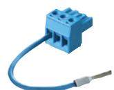
Point de référence externe pour 1 x thermocouple (Pt100 dans un montage deux fils) intégré dans une borne enfichable (3 pôles). Le montage s'effectue dans le dispositif ISpac au lieu de la borne de connexion standard.
