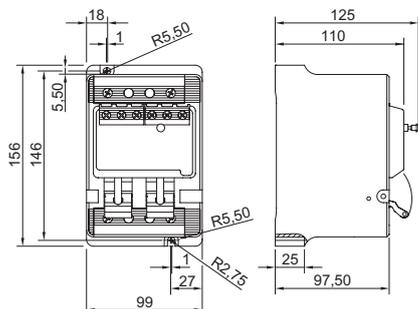
8562/54-....., 2 pôles avec contact auxiliaire
