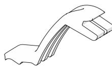
La sécurité antichute du couvercle du luminaire empêche toute chute accidentelle du couvercle après ouverture du luminaire.
