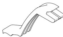
La sécurité antichute du couvercle du luminaire empêche toute chute accidentelle du couvercle après ouverture du luminaire.
