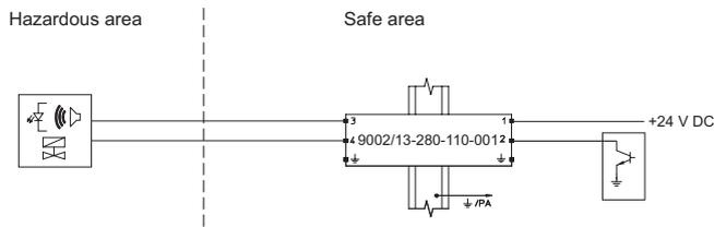
Caso de aplicación: salida discreta de 2 conductores para válvulas solenoides, LED y equipos de señalización
