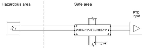
Caso de aplicación: Pt100, circuito de campo flotante de conexión de 2 conductores
