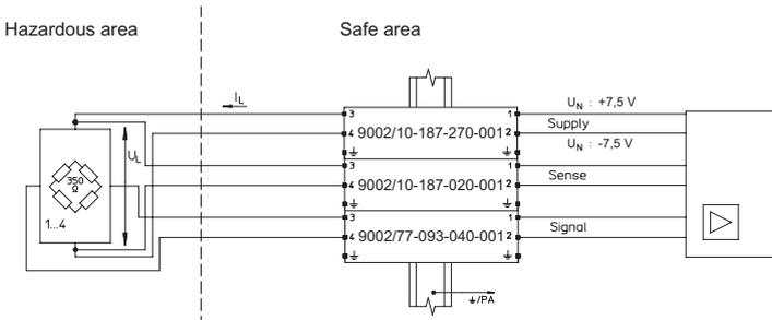
Caso de aplicación: célula de carga (DMS) 350 Ω o 700 Ω 6 conductores +/- circuito de campo flotante de 7,5 V (15 V)
