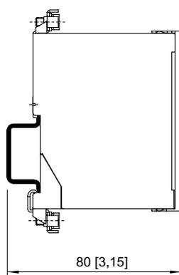
Montado en rail de montaje DIN NS 35/15
