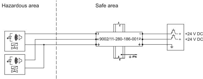
Caso de aplicación: salida discreta de 2 conductores para válvulas solenoides, LED y equipos de señalización
