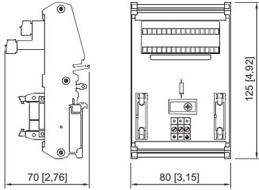
Placa de conexiones HART, tipo 9196/16H-XX0-03c
