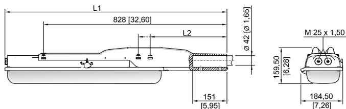
Con adaptador de montaje en poste
