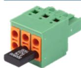
La señal 0/4...20 mA del canal 1 se convierte en una señal 0/2...10 V. El elemento de acoplamiento de la resistencia sustituye al terminal de conexión existente. (kit con 5 piezas)
