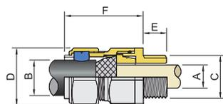
A = Recubrimiento interno máximo
