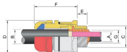
A = Recubrimiento interno máximo
