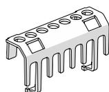
La protección contra contactos accidentales sirve para proteger a los técnicos de mantenimiento e instaladores eléctricos contra el contacto involuntario con piezas conductoras de electricidad. El tipo de protección aumenta a IP20 al utilizar la protección contra contactos accidentales.
