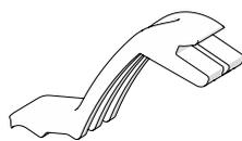
La protección contra caídas para las cubiertas de luminarias evita la caída accidental de la cubierta al abrir la luminaria.
