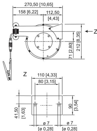
Pinza de puesta a tierra con enrollador automático de cable
