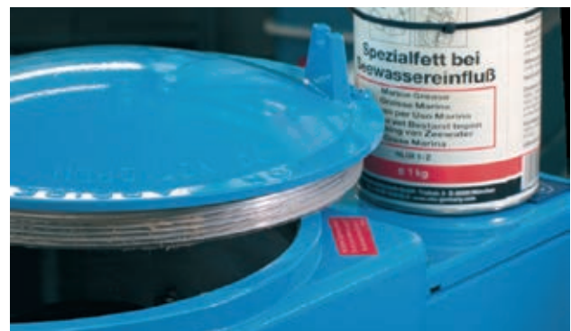
Bild 9: Verwendung von korrosionshemmenden Fett
