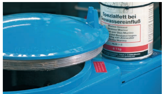
Bild 9: Verwendung von korrosionshemmenden Fett
