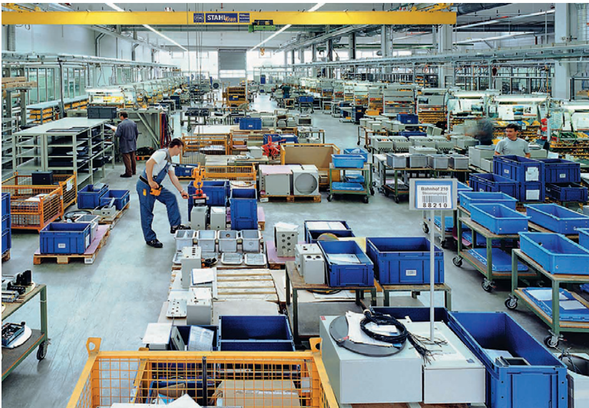
Flexible Fertigungslinie im Steuerungsbaue am Standort Waldenburg. Im Bildabschnitt rechts hinten zu sehen: dickwandige Gehäuse in der Ausführung „Ex d“.
